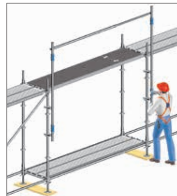
Afbeelding 18: Gebruik van een montageleuning bij niveauwisseling
