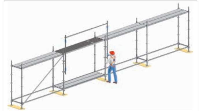
Afbeelding 18: Gebruik van een montageleuning bij niveauwisseling
