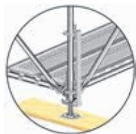
Afbeelding 83: Voetspindel bevestiging met staander koppelstuk
