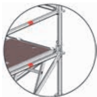
Afbeelding 84: Verbinding van de staanders met borgpen
